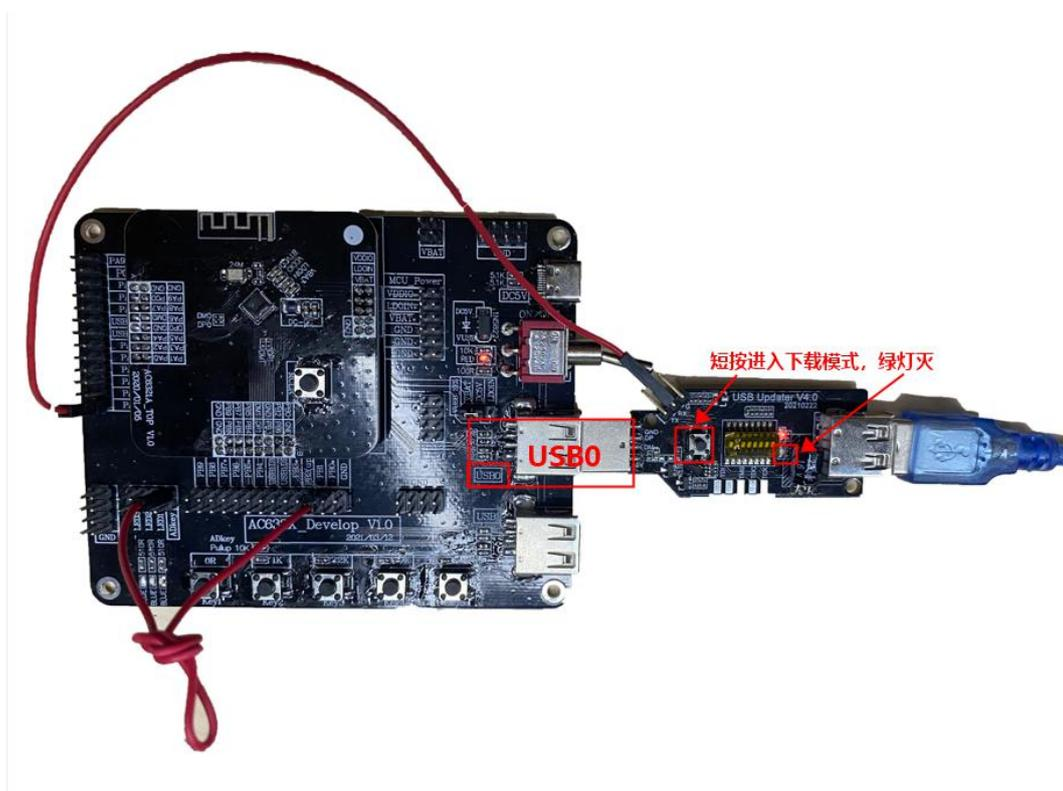
2)、想退出程序下载模式，让开发板正常运行跑起来：只需要让开发板断电再上电，可通过重新插拔一下升级工具和开发板的 USB 连接即可。升级工具（绿灯闪亮）只供电给开发板。
