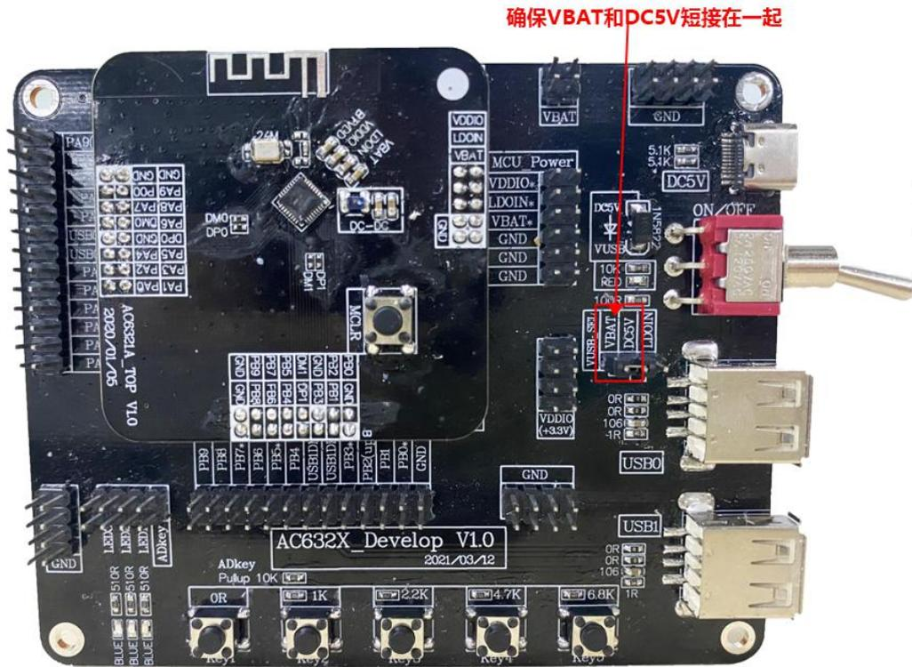
2)、如果按照上面接线还是无法解决,那就确实是供电电压偏小了一点。可以检查一下供电电源是否是5V。(如果非要使用这个电源供电的话,将板级配置中电压检查关闭即可。如下图所示)
